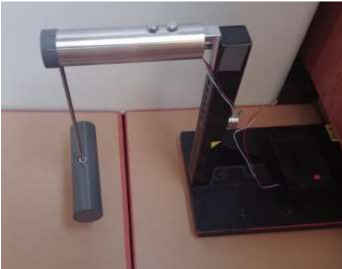
2. ábra Erőmérő állvány a róla lelógó mérőszárral és rajta egy hengerrel. A fényes cső a szélvédő burkolat, azon belül van az erőmérő cella.
