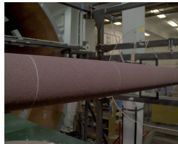
k_s = 0,4\text{-}0,5 \text{ mm} ( k_s/D = 0,4\% ) csiszolópapír
