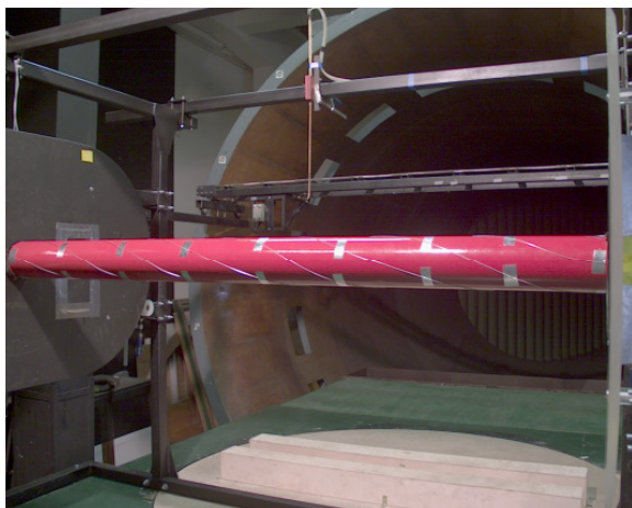
d = 1 \text{ mm} ( d/D = 0,88\% ) fémhuzalból 4 bekezdésű, 8D menetemelkedésű spirál
