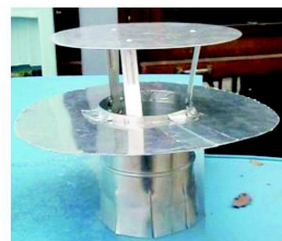
7. ábra. A vizsgált kitorcollás-módosító szerkezetek: a) Meidinger-tárcsa kör, illetve négyzet alakú fedőlappal, b) Meidinger-tárcsa a kitorcollás síkjában lévő „gallérral”
