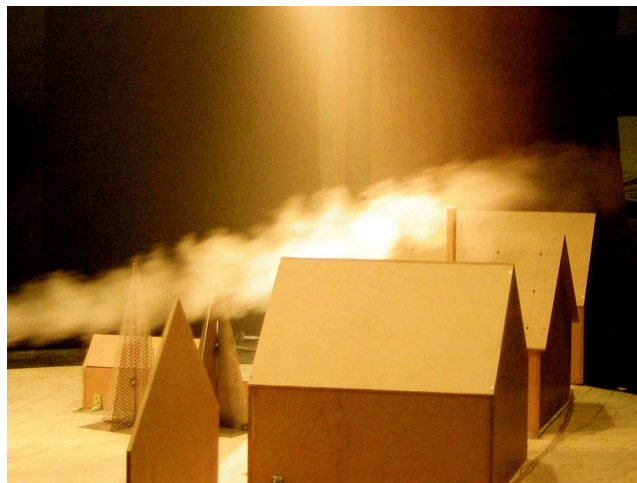
1. ábra. A kémény ferde megfúvása az épületek áramlást fékező hatására
