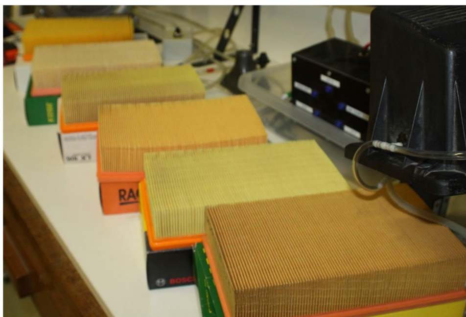
Normál (ún. panel) papír légszűrők kialakítása, szűrőfelület részletei
