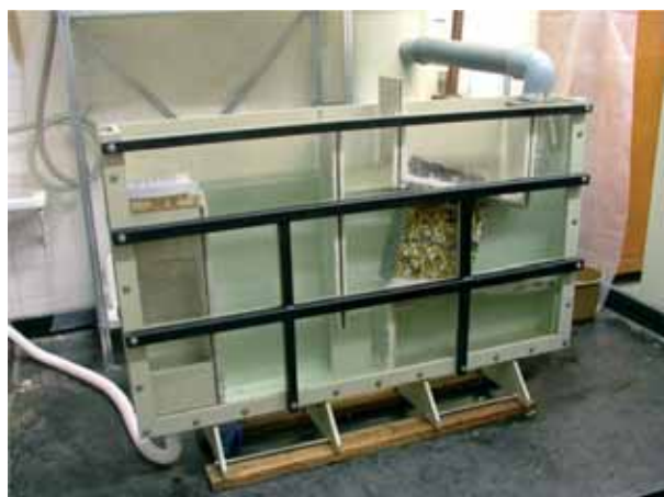
2. ábra. Bevonattal ellátott kavicságyas szűrőbetét olajleválasztás közben Fig. 2: Coated gravel bed oil-water separator in operation
