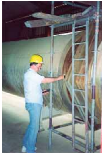
3. ábra: Forró füstgáz hőmérsékletmérése
