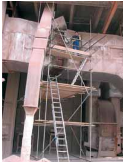
2. ábra: Prandtl-csőves sebességmérés Fig. 2: Velocity measurement using a Pitot-static probe
