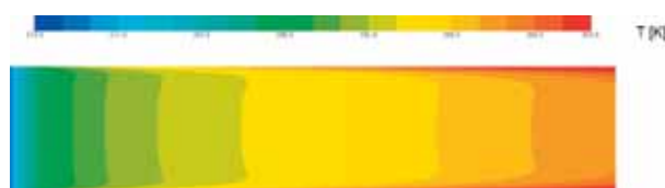
1. ábra. Hőmérsékletkontúrok a fűtött, bordázatlan, egyenes hőátadó felületen
