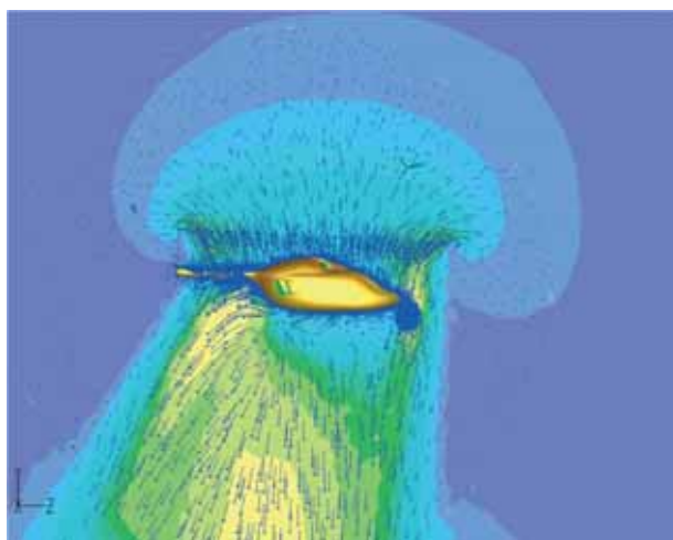
1. ábra. A helikopter körüli áramlás lebegéskor Fig. 1: The flow around the helicopter at hovering
