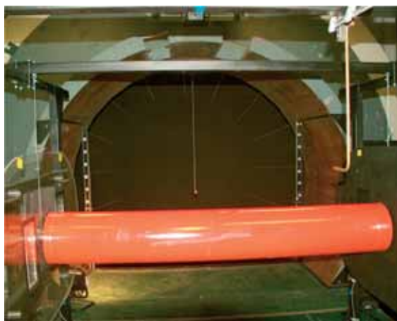
1. ábra. Hengeres toronyelem a szélcsatorna mérőterében Fig. 1: Structural member of a mast in the test section of the wind tunnel
