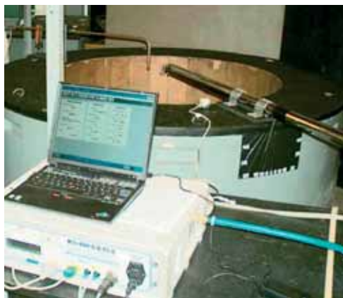
1. ábra. Izokinetikus poremisszió mintavevő mérőkör-kalibráció
