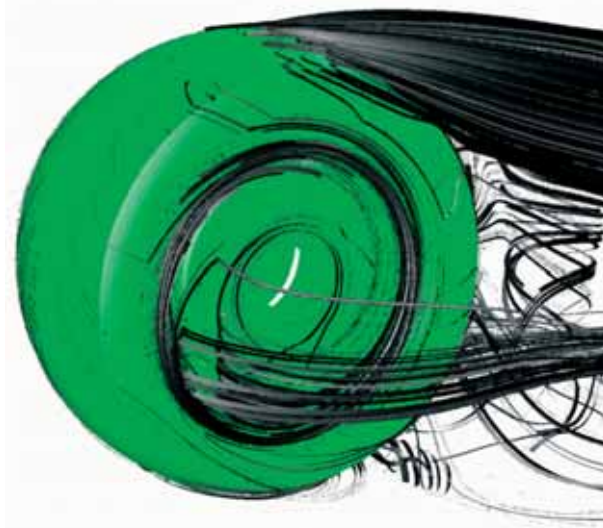
3. ábra. Áramvonalak a vizsgált kerék körül Fig. 3: Streamlines past the wheel of interest
