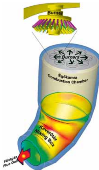
4. ábra. Hőmérséklet-eloszlás a keverőtér felületén Fig 4: Temperature distribution of the surface of Mixing Box
