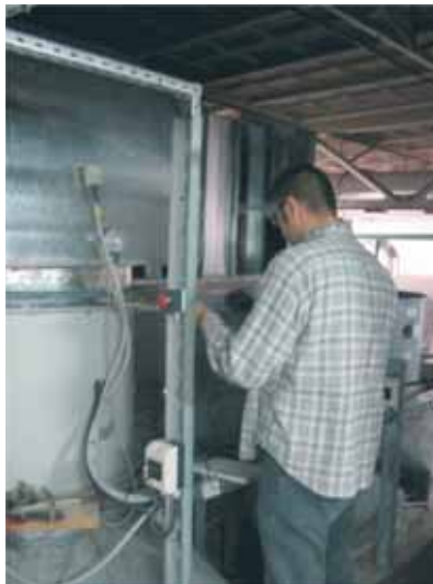
1. ábra. Sebességmérés hőgömbös anemométerrel Fig. 1: Velocity measurement using a thermal anemometer
