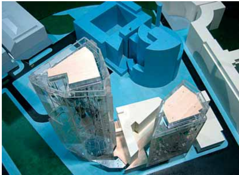
2. ábra. A magasházak szélcsatornamodellje Fig. 2: Wind tunnel model of the towers
