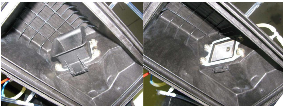
1.2 ábra: Légszűrőház terelőelemmel (b) és terelőelem nélkül (j)
