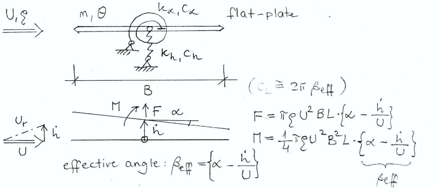
$$\begin{bmatrix} m & \theta \end{bmatrix} \begin{bmatrix} \ddot{h} \\ \ddot{\alpha} \end{bmatrix} + \begin{bmatrix} c_h & c_x \\ c_h & c_x \end{bmatrix} \begin{bmatrix} \dot{h} \\ \dot{\alpha} \end{bmatrix} + \begin{bmatrix} k_h & k_x \\ k_x & k_x \end{bmatrix} \begin{bmatrix} h \\ \alpha \end{bmatrix} = \underline{Q}(x, \dot{x}) \quad x = \begin{bmatrix} h \\ \alpha \end{bmatrix}$$
