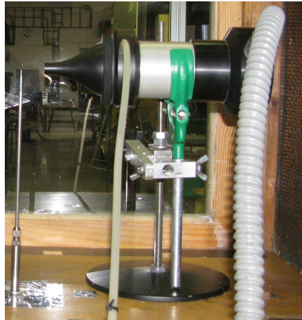
2. kép - A kalibrálás elrendezése (hődrót és fúvóka egymáshoz képesti helyzete)
