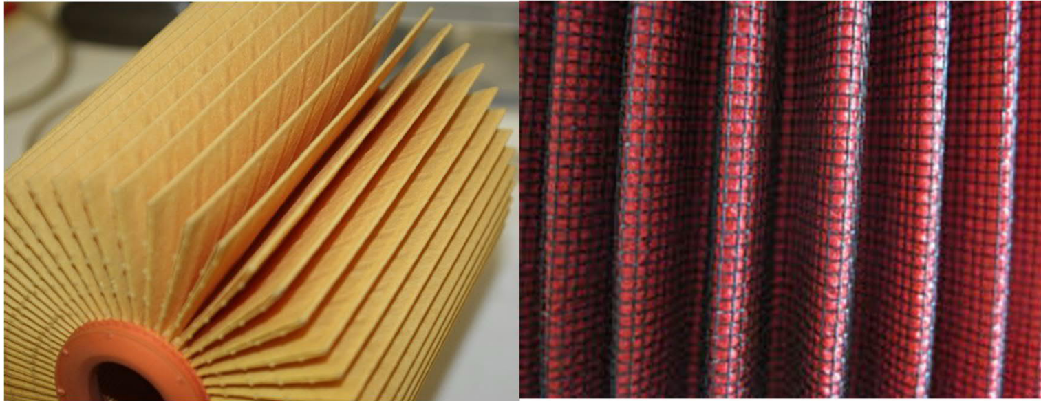
3.1 ábra: Szerkezeti eltérés a Bosch (és az össze többi), illetve a K&N gyártmányú légszűrő között
