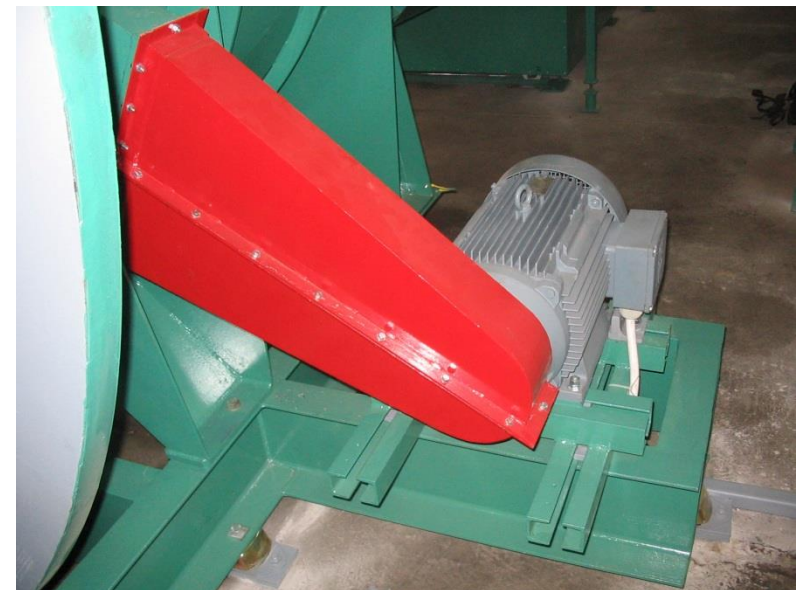
Profilos lapátoszású járókerék orrkúppal, közvetett hajtás, profilos lapátoszású utóterelő
