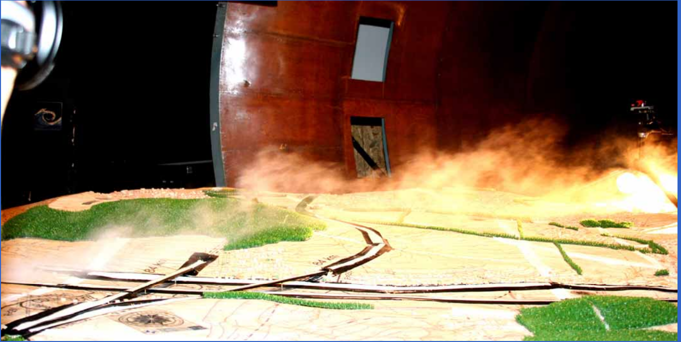
3. ábra Az olajköd elkeveredése a solymári csomópont szélcsatorna modellje fölött
