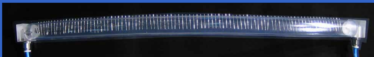
10. ábra Vonal menti forrásnál alkalmazott nyomgáz elosztó cső
