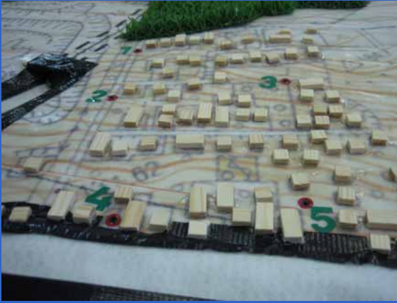
11. ábra Számokkal jelzett mintavételi furatok és a modell alatti piros mintavevő csövek
