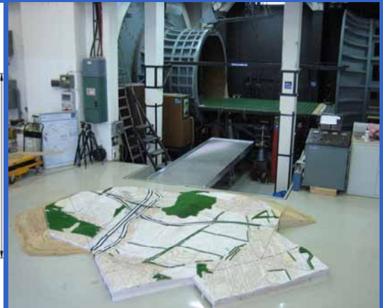
4. ábra Az Áramlástan Tanszék vízszintes szélcsatornája (előtérben a solymári csomópont modellje)
