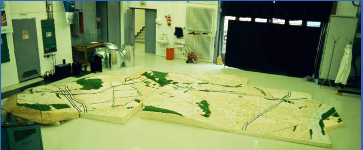
7. ábra A teljes terep modell az Áramlástan Tanszék laboratóriumában
