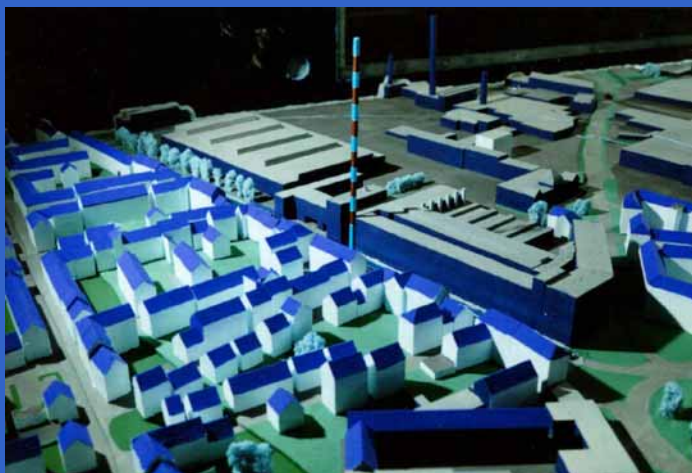
5. ábra Városban és szélcsatorna modellen végzett mérések összehasonlítása
